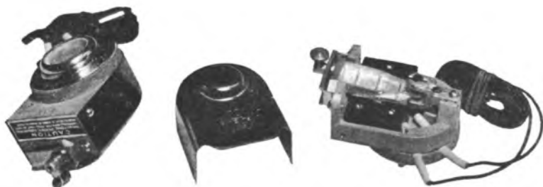
De electro-statische weergever compleet en gedemonteerd. De modellen zijn ongeveer op halve grootte gereproduceerd.
