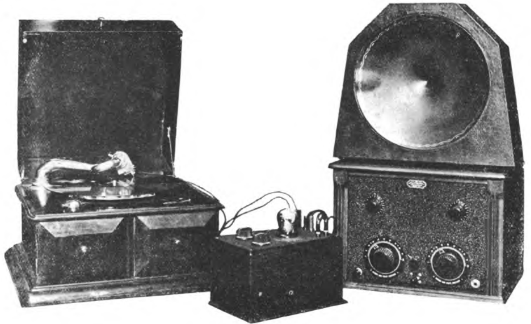
Onze foto toont hoe een radio-amateur, in het bezit van een toestel met tenminste 3 lampen (0-1-2) en luidspreker, tevens een gramfoon bezittend, met behulp van zijn radio-apparatuur een aanmerkelijk betere reproductie van zijn gramfoon kan bereiken. Alles wat daartoe extra noodig is, de condensator-weergever en de oscillator, wordt in dit artikel beschreven.
